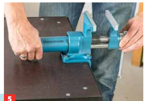
5 ... der Heuer Compact -Schraubstock mit Schnellverstellung und Tischklammer.
