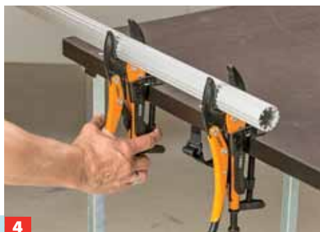
4 Sinnvolles Zubehör, das ebenfalls vom Hersteller angeboten wird, sind die Piher Gripzangen samt Tischhalterung sowie ...
